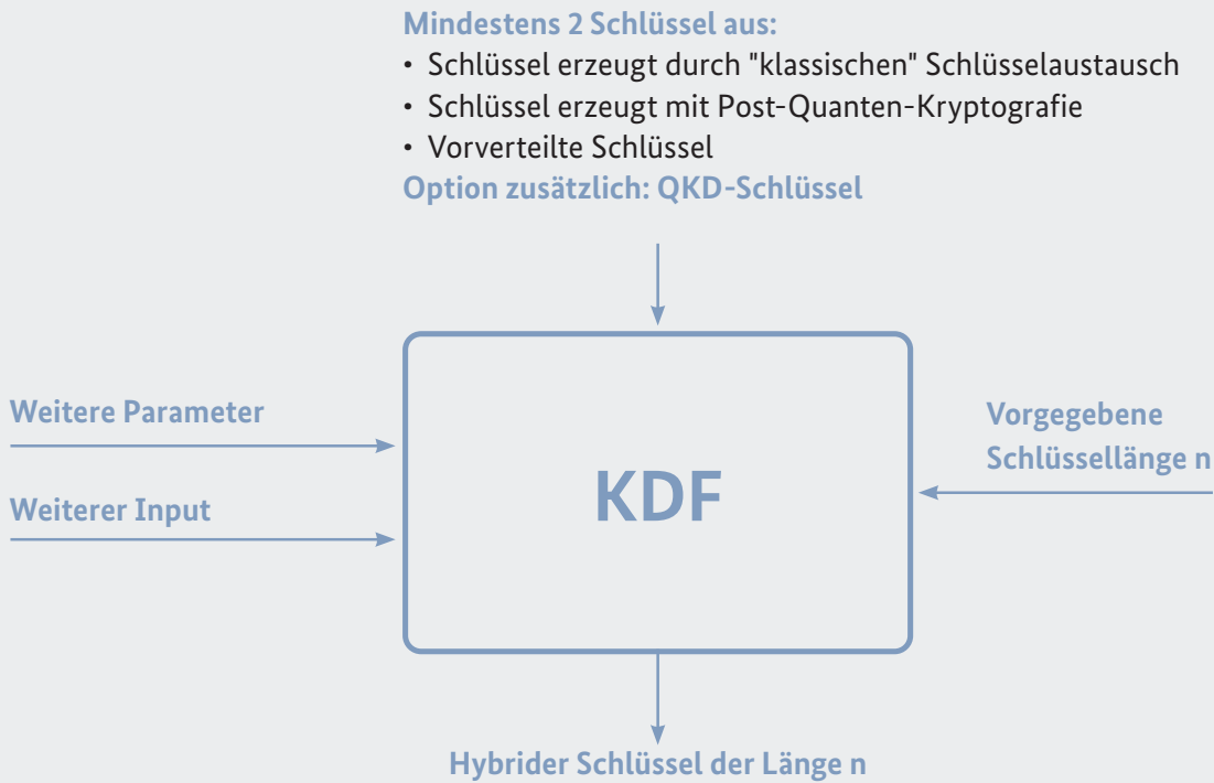
Abbildung: Schematische Darstellung der hybriden Schlüsseinigung mittels einer Key Derivation Function (KDF)
